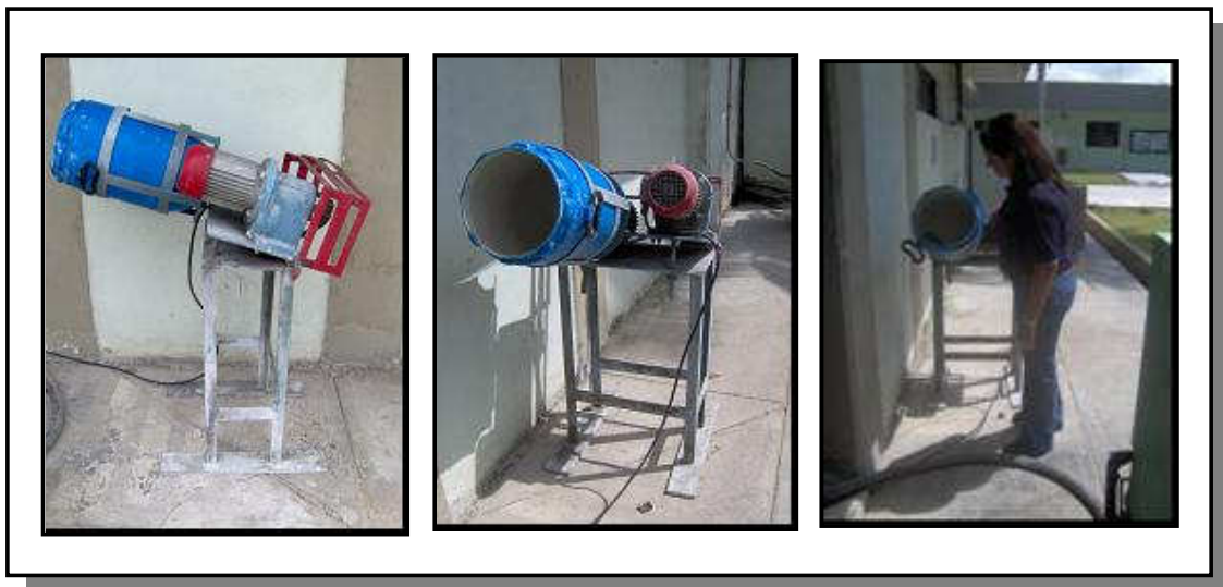
Figura 2. Tambor rotatorio utilizado para realizar pruebas de Fluidibilidad.
