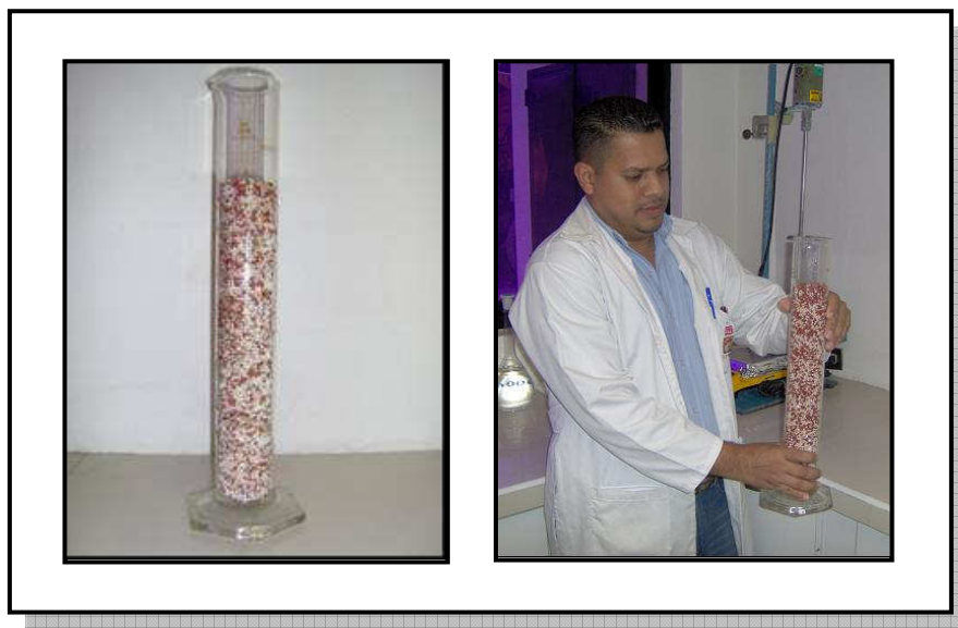
Figura 3. Cilindro graduado con mezcla de fertilizante, utilizado para medir el MHC.
